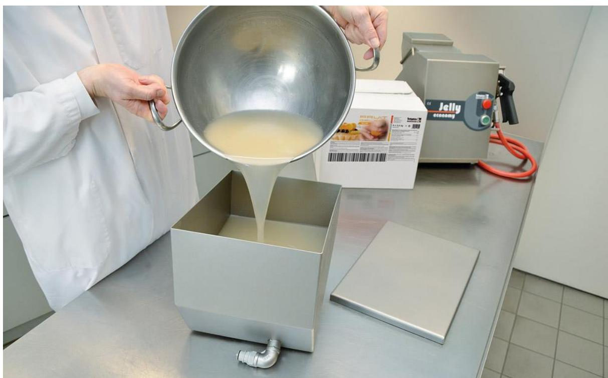
Versare la gelatina già miscelata nel contenitore sulla macchina e posizionare la valvola della temperatura a 84° Celsius
